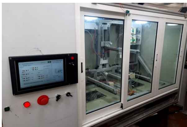
Рис. 1. Установка трехканального электроспиннинга
