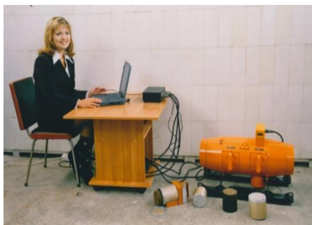
Рисунок 1. Общий вид анализатора АНКР-3М: 1 – измерительный блок; 2 – концентратор; 3 – компьютер; 4 – образцы керна
