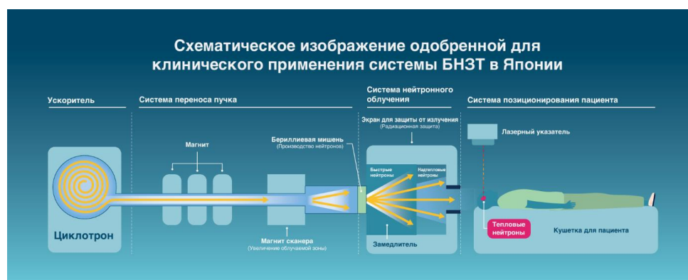
Рис. 2. Схематическое изображение одобренной для клинического применения системы БНЗТ в Японии
