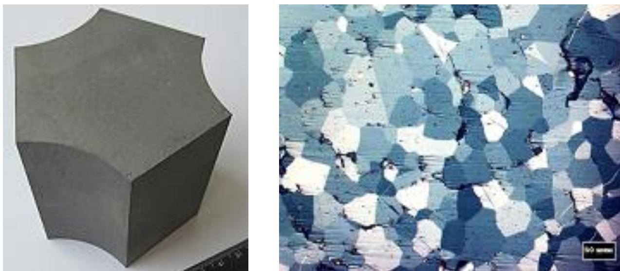
Рис. 1. Прототип блока замедлителя/размножителя нейтронов в виде «трилистника» и микроструктура изделия в поляризованном свете
